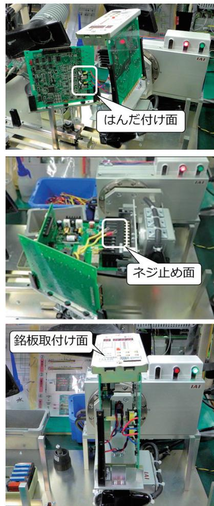
図14 組立協働ロボット（組立面の自動転回）
