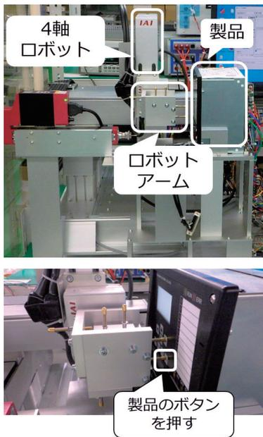
図13 製品のボタン・スイッチ操作を行うロボット
