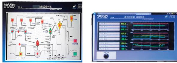
a) 注型設備一覧画面 b) 硬化炉の温度計測表示画面
