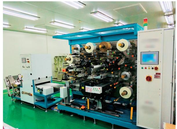
図8 コンデンサ素子の自動素子巻機
