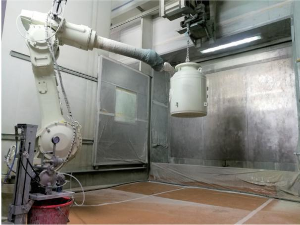
図11 Gas-VT用塗装ロボット
