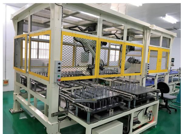
図10 Gas-VT用自動鉄心積機
