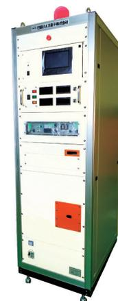
図3 インバータパルス発生器
