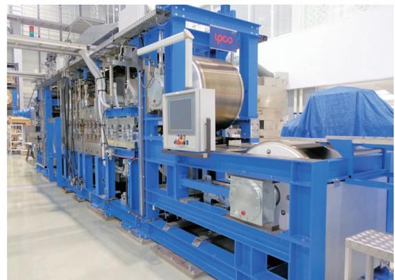
図1 ダブルベルトプレス
