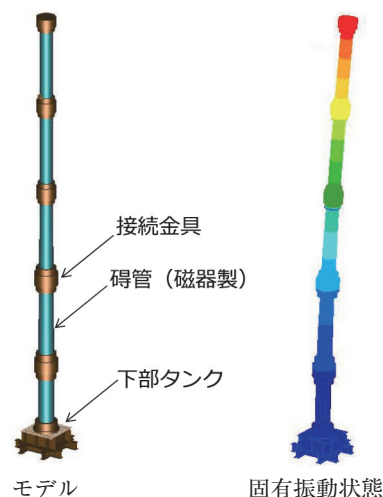
図3 CVTの耐震解析例
