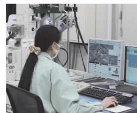
2)無機元素分析、電子顕微鏡観察 ・含有元素分析 ・表面/断面の高倍観察（約10万倍） と観察面の元素分析
