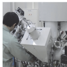
3)表面分析 ・極表面分析、薄膜分析 ・化学結合状態
