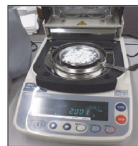
4)加熱水分測定試験 ・絶縁紙測定 ・粉体の含有水分測定
