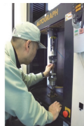
2)引張試験 ・引張強度及び伸び測定 ・接着力測定、ばね定数測定
