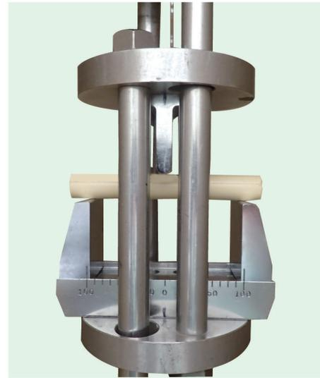
図3 樹脂材料の機械特性試験
