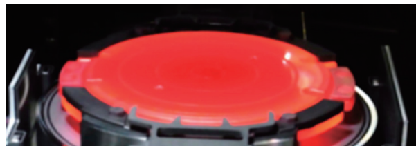
図2 メカクランプ付き高温ESCモジュール
