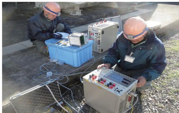
図16 保護継電器調整試験
