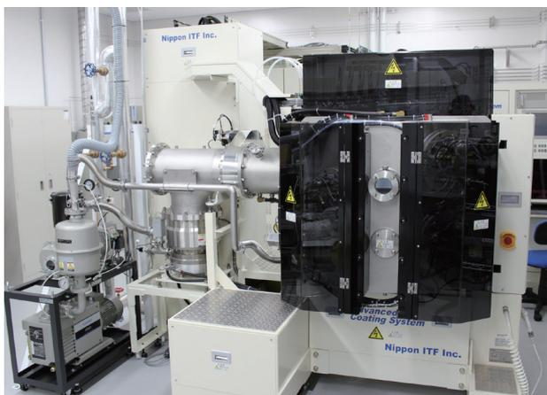
図2 当社製PVDコーティング装置「M500C-303型」<sup>(1)</sup>
