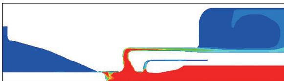
図7 ガス遮断器の消弧室の熱流体解析例
