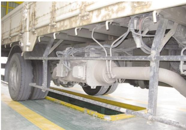
図8 走行耐久試験車両に装着された電気ヒータ再生式DPFシステム 999
