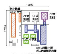
図7 改修後機器配置図
