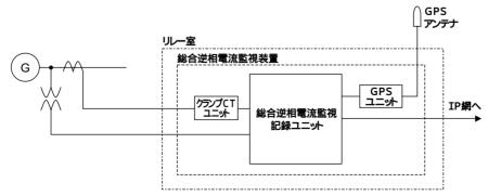
図10 総合逆相電流監視装置の構成
