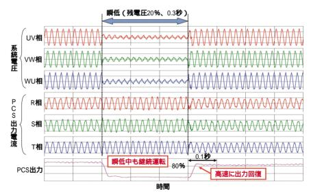
図3 瞬低試験結果(FRT機能の検証)
