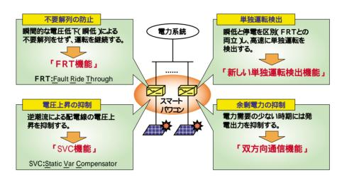
図2 太陽光発電装置の大量連系でパワーコンディショナに必要となる機能
