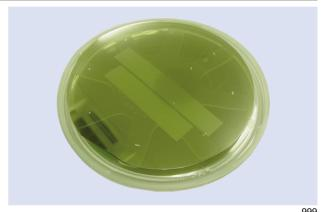
図8 MSE成膜を施した3インチSiC基板
