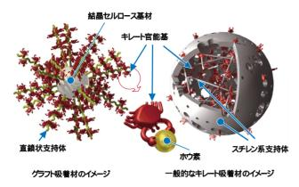
図 9 グラフト吸着材と一般的なキレート吸着材の構造模式図
