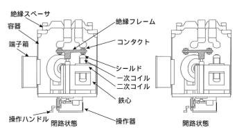
図3 絶縁フレームセンター操作方式構造図
