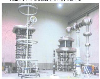
図7 三相ID付きガスVT 耐電圧試験状況
