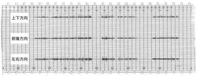
図8 三相ID付きガスVT 輸送試験時の加速度記録
