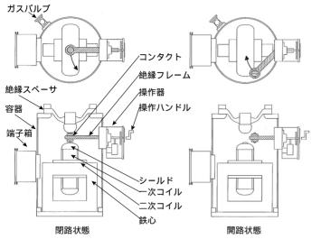
図1 コンタクト回転方式構造図
