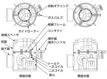
図2 絶縁フレーム側面操作方式構造図
