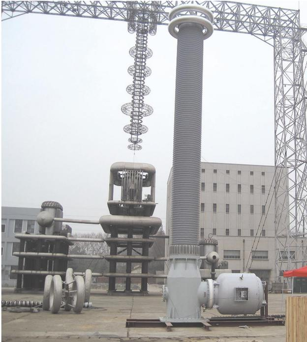
図19 1100kV ガスVT 試験状況
