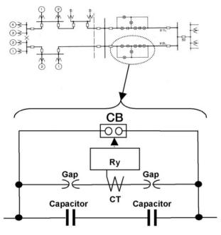
図9 直列コンデンサ設備構成
