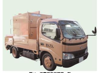
図12 工事用変圧器車 型
