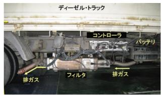
図10 車載走行試験(装置装着状況)
