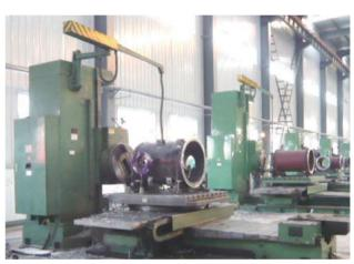
図4 中ぐり盤での加工状況
