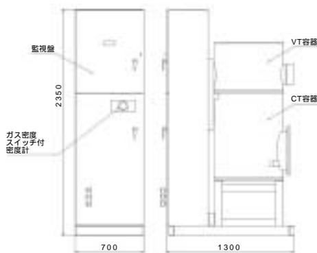
図6 23kVガス絶縁VCT外形図
