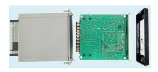
内器をケースより引出せます。 電流端子は自動的に短絡します。
