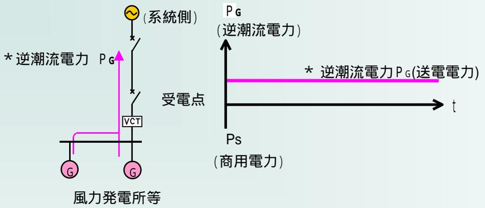
(2) 短時間の逆潮流(構内発電機運転中の負荷の変動・脱落等による一時的な逆潮流)
